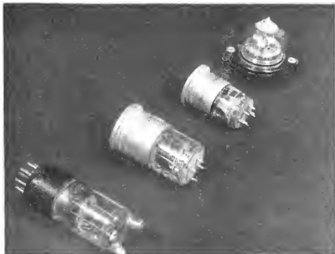
Fig. 1 - Triodi commerciali di piccole dimensioni per trasmissione su onde U.C. Dall'alto verso il fondo: CV 6; LD 6; LD 1; RD 2,4 TA.
