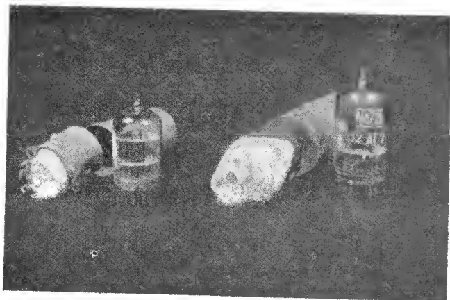
Fig. 23 - Le valvole per O U C più moderne: a sinistra: 6AK5 (miniatura); a destra: 12AT7 = ECC81 (Noval) con i rispettivi zoccoli ceramici.
