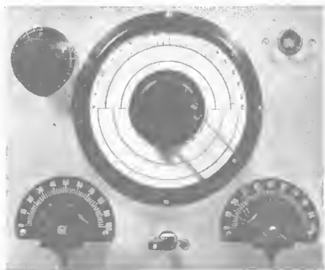
Fig. 28 - Vista anteriore del ricevitore per dilettanti con scala tarabile.
